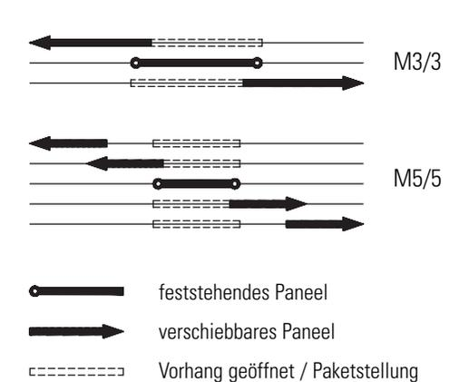
Die einteiligen Anlagen sind mit Paketstellung links dargestellt. Für Paket rechts lautet die Ausführung z.B. R4/4.
