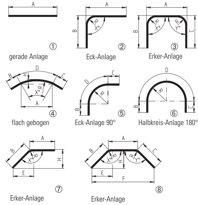
Angeführte Skizzen zeigen die Anlagen-Draufsicht. Abmessungen gelten für Schienenmitte.
